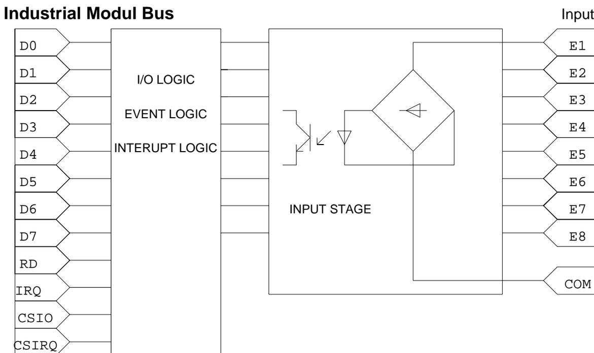
**Tension d'entrée** : 24V nominal, 30V maxi., 12V mini, tension AC ou DC
