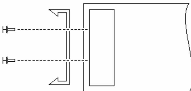
Si vous désirez monter votre système sur rail DIN, effectuez le montage du kit selon la figure ci-dessus. L'arrière du module d'I/O est percé au diamètre des rivets.
